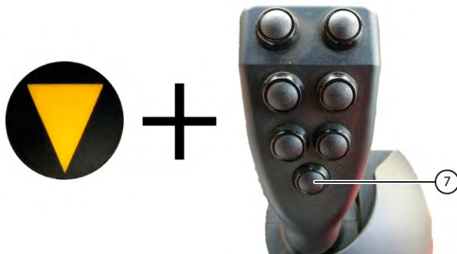
Fig. 51 Activer la télécommande
