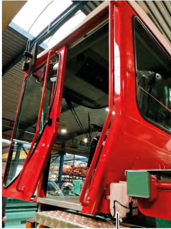
Fig. 13 Réservoir du liquide de lave-glace
