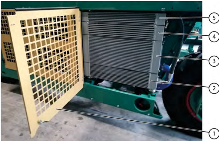
Fig. 91 Nettoyer les radiateurs
