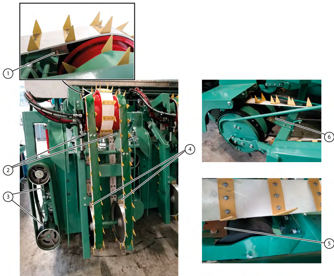
Fig. 80 Emplacement des racleurs
