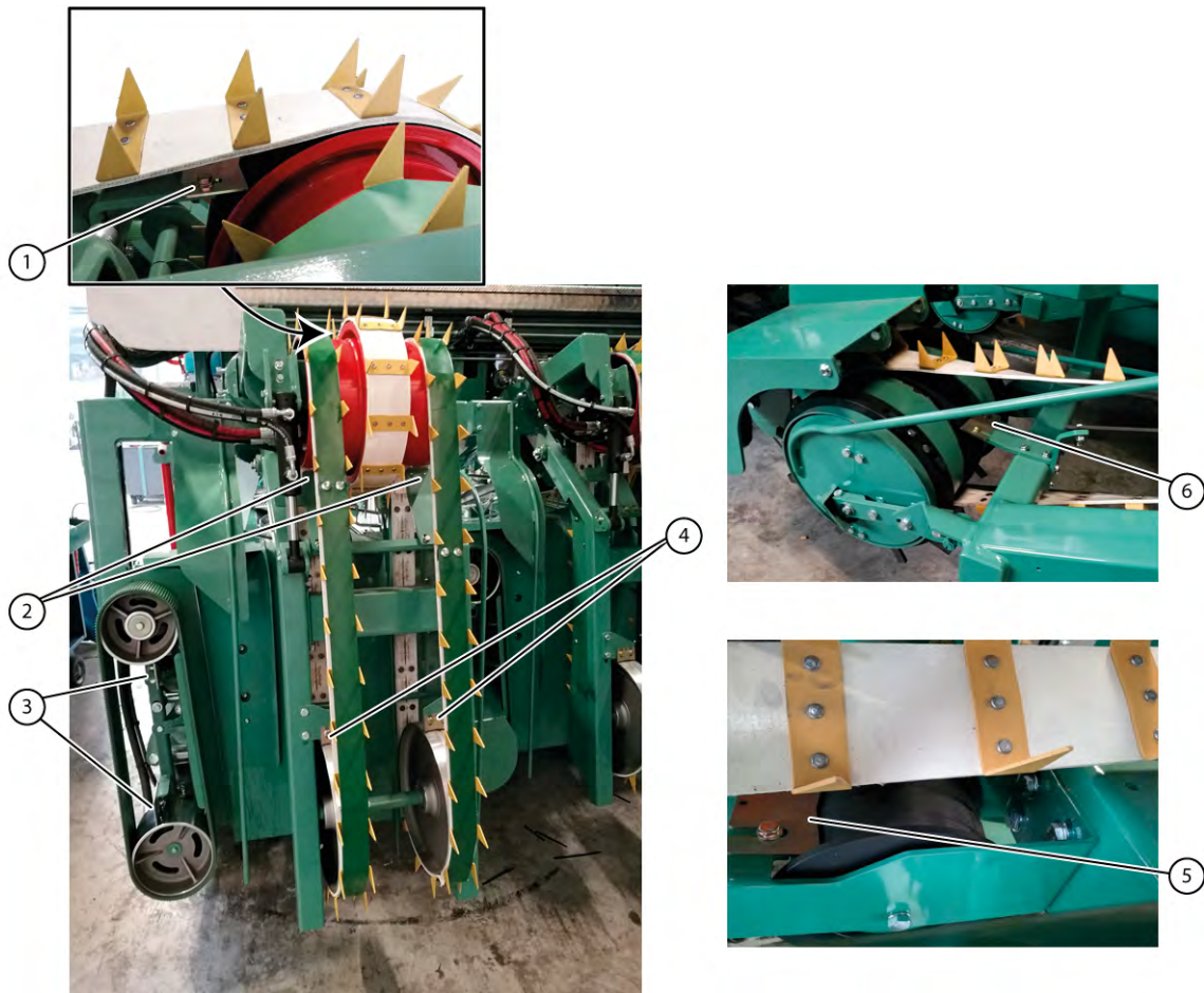
Fig. 109 Emplacement des racleurs
