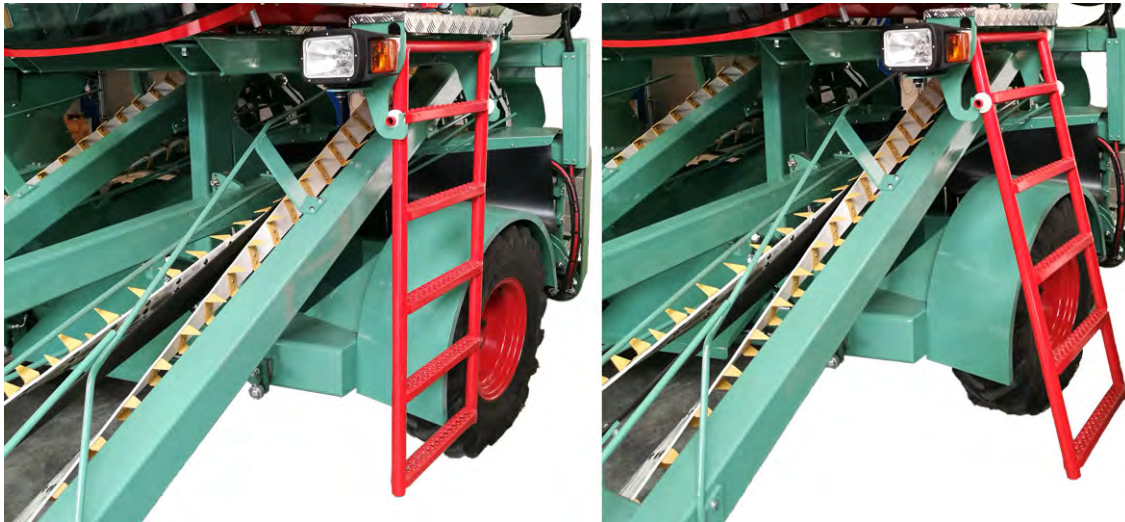
Fig. 10 Échelle repliée et dépliée
