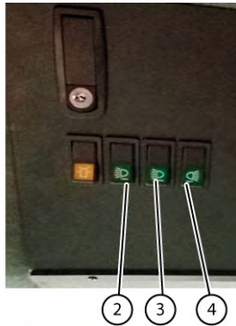
Fig. 50 Boutons de commande des feux de travail
